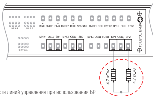
Рис. 45. Контроль целостности линий управления при использовании БР
